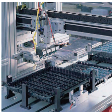
LXM 32伺服驱动器控制拾放式机器人
